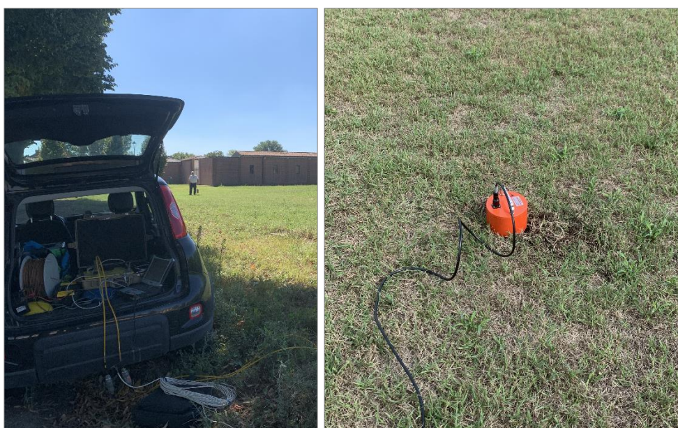
Figura 6: Prova MASW Area 3 e campana geofono triassiale per prove HVSR
